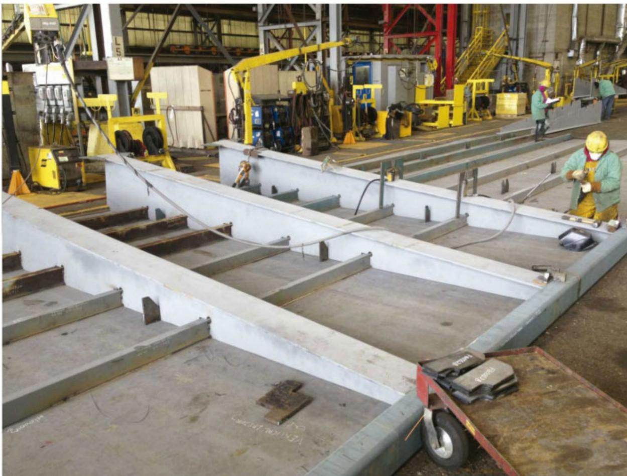
Fig. 1 — Los trabajadores ensamblan y sueldan el armazón de un barco.
