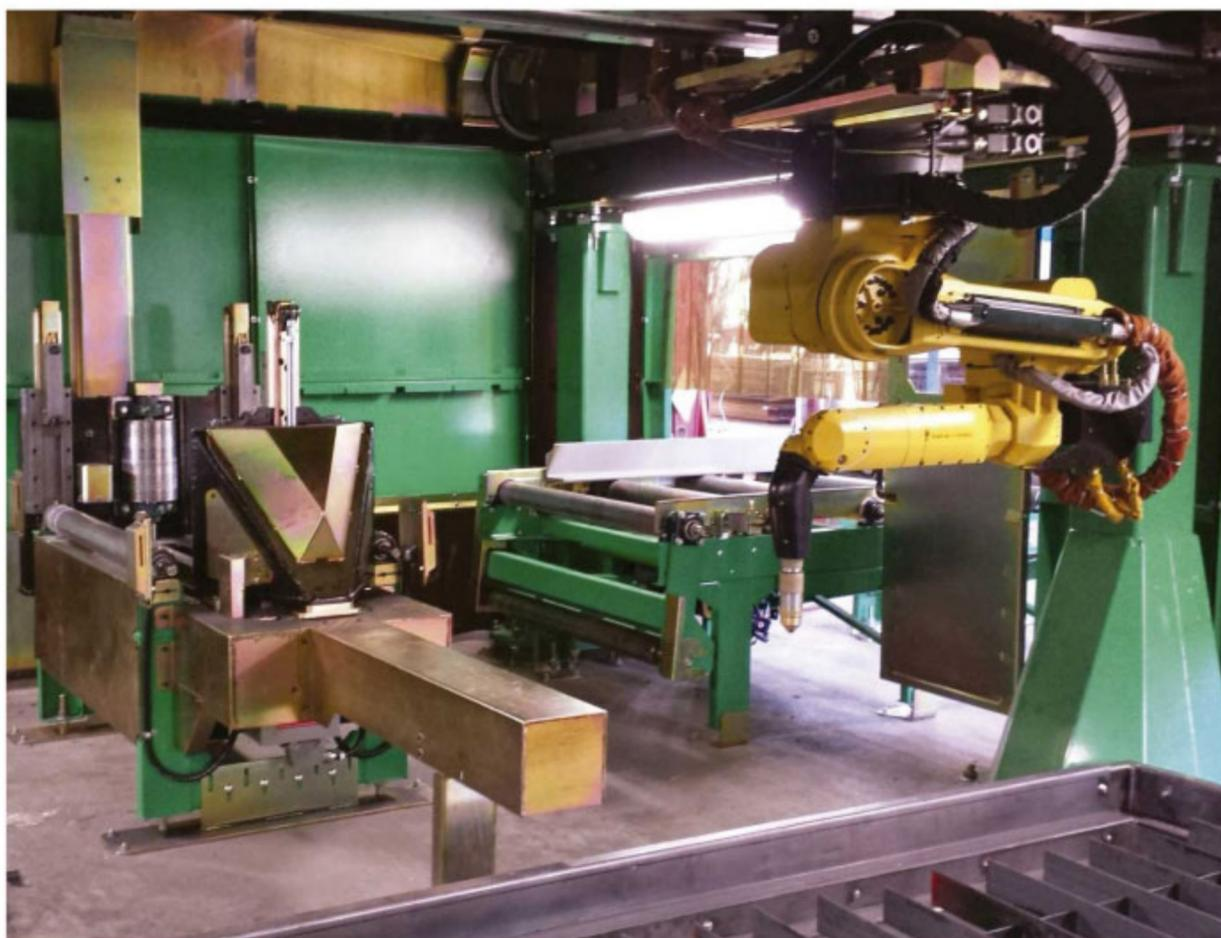
Fig. 3 — Se utiliza un sistema de doble propósito con corte de línea de haz robótico y corte de placa estándar para cortar una forma 3D.
